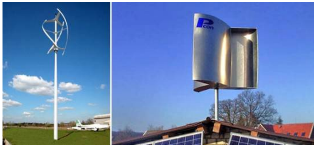
Eoliennes domestiques type «Savonius» ; de grande et petite taille.
