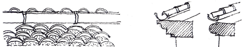
Corniches briques (motif de petites consoles, 1), dalles de pierres horizontales (2), génétoises en tuiles creuses (3, 4), corniches en pierre (5, 6).
